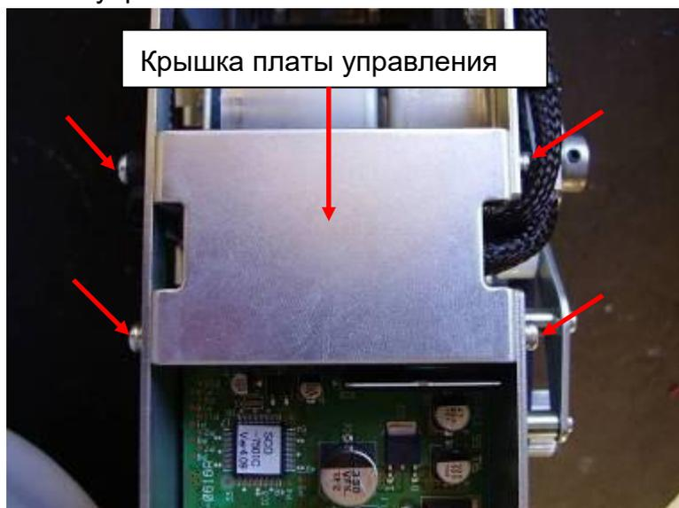
Отсоедините разъем основного жгута проводки, датчика пустой кассеты, двигателя и соленоида от платы управления и выкрутите 4 винта М3 х 5мм, которые фиксируют плату.
