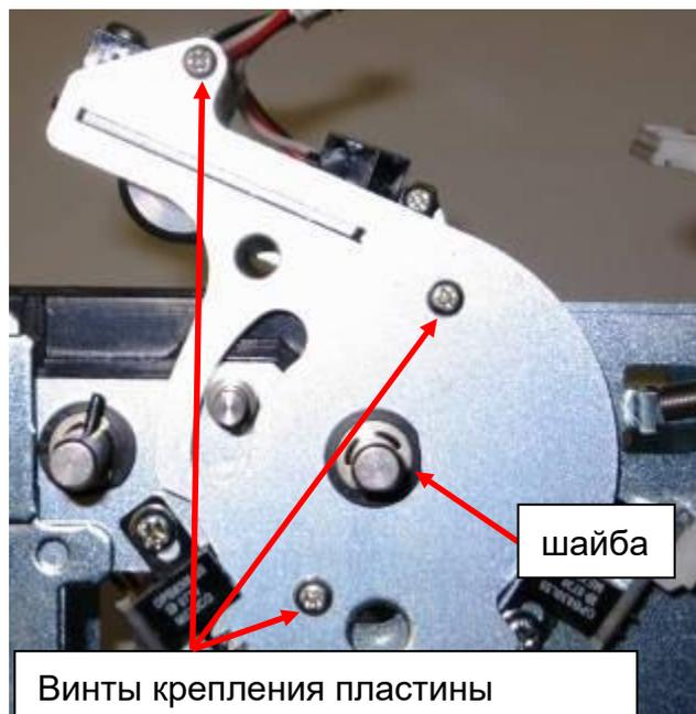
Снимите разрезную шайбу 4мм на левой стороне устройства на пластине механизма захвата карты. Выдвиньте влево весь остальной механизм захвата карты.
