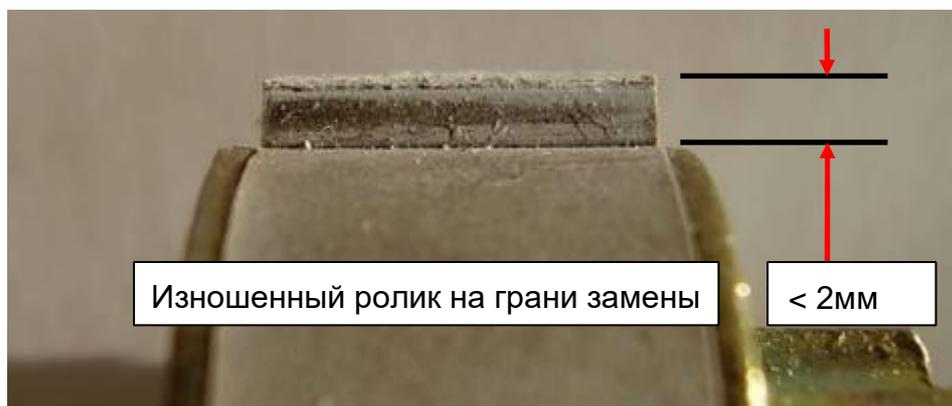
Если ролик еще не нуждается в замене, его необходимо очистить с помощью изопропиловой чистящей жидкости или слабым раствором любой другой моющей жидкости на водной основе. Вращайте ролик вручную, очищая все поверхности, вступающие в контакт с картой.
