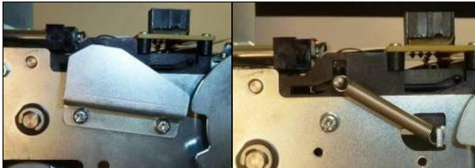
Отключите 2 разъема на гибком шлейфе и выкрутите 2 винта М3 х 14мм, крепящих гибкий шлейф спереди и оптический датчик.
