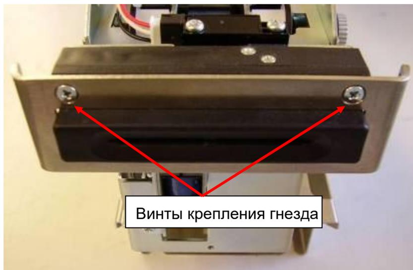
Поднимите вручную механизм захвата карты и проверьте нормальную протяжку карты.
