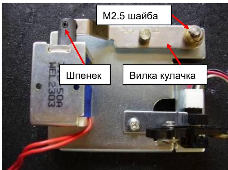
Установите новый соленоид на кронштейн, прикрутите 4 винта М3 х 5мм. Установите новый шпенок в сочленение сердечника соленоида и вилки кулачка. Вставьте сердечник в соленоид вместе с вилкой и закрепите вилку разрезной шайбой М2.5.
