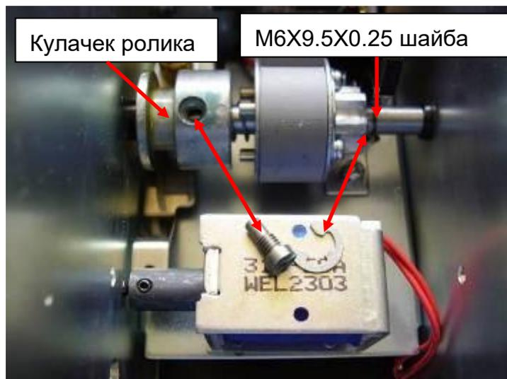
Аккуратно выдвиньте вал в правую сторону настолько, чтобы можно было извлечь резиновую часть ролика-защелки.
