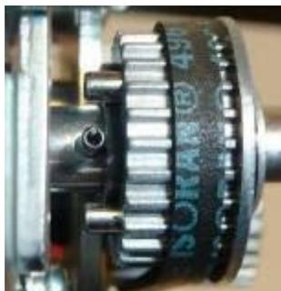
Убедитесь, что срезанная плоскость на валах совпадает с углом стопорных винтов на роликах перед затяжкой.
