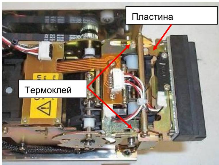
Подайте питание на устройство и нажмите кнопку 'Control' на тестовой плате Test PCB как минимум 10 раз, чтобы проверить правильную работу механизма и отсутствие отскока в нижнем положении. Если будет наблюдаться отскок, повторите процедуру калибровки.
